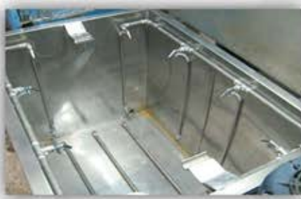
מתקני ניקוי ושטיפת חלקים בלחץ גבוה עם זרמים בעוצמה גבוהה וחימום
